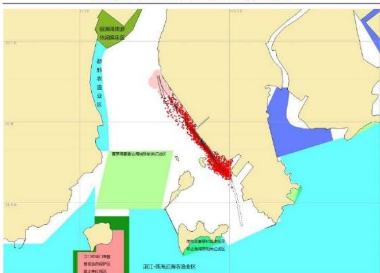
图 9.2.2-2 夏季常风条件下溢油 72h 油膜漂移位置及影响范围（落潮期）
